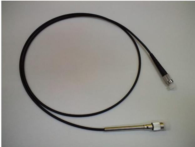
・テーパ光ファイバは、入力大きい口径で出力が小さい口径をした形状の光ファイバで、レンズでは絞れないスポットサイズを実現致します。
