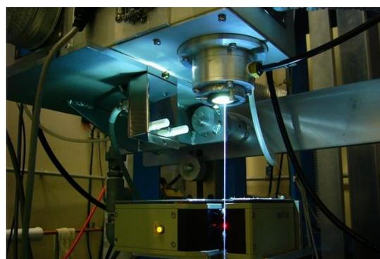
抵抗加熱炉で任意径で引き出された光ファイバは、2層のUV硬化樹脂でコーティングされ、ドラムに巻きとられます(右図)。各コーティングユニットの後段には、外径測定器が取り付けられており、コーティング外径が測定されております。
